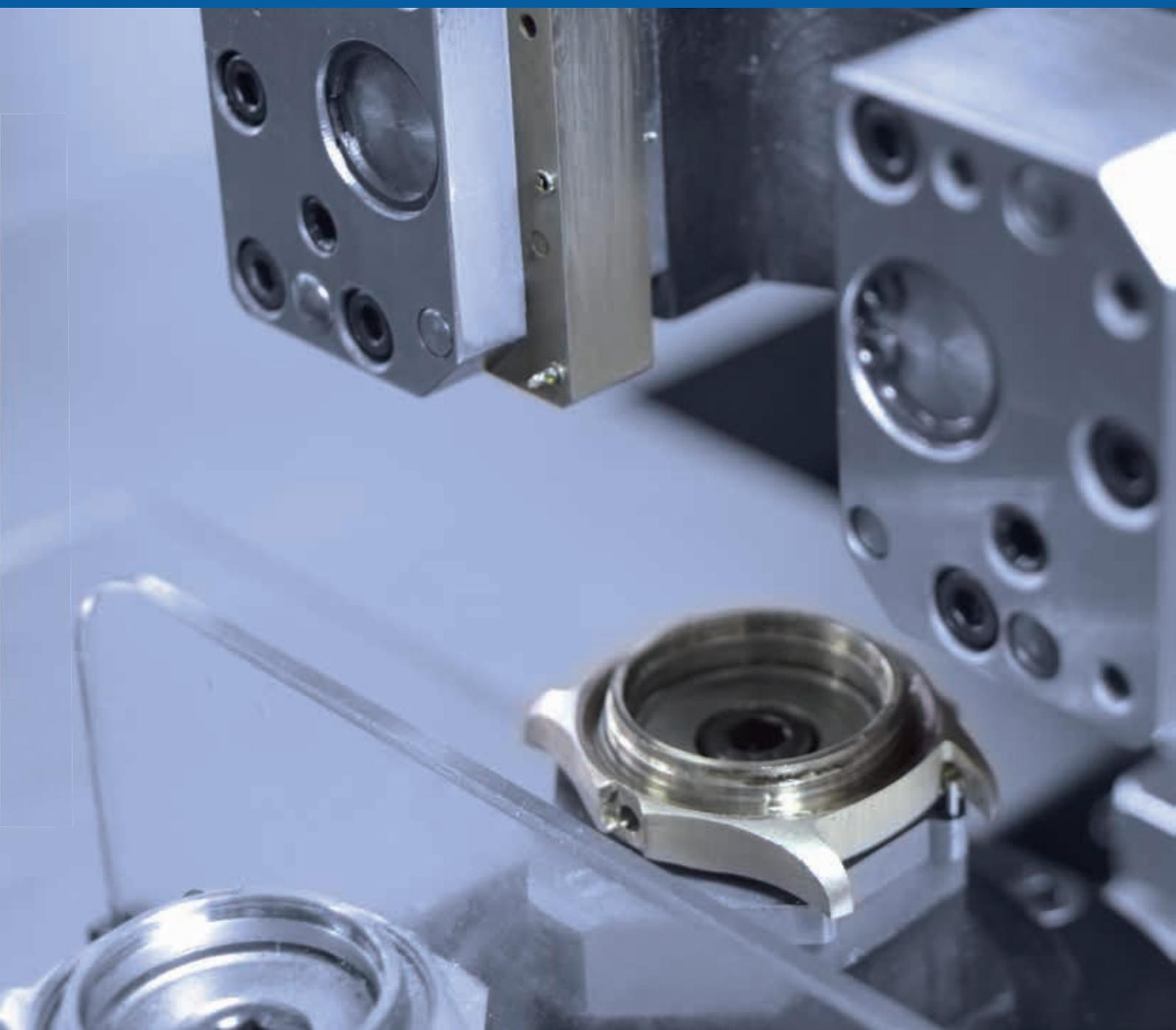
MAGIC est une machine d'établi à 3 axes dédiée à l'horlogerie pour le perçage des trous de barrettes de montres. **Ce concept d'usinage est unique au monde.** Le procédé de MAGIC est de percer simultanément deux trous de barrette à la perpendiculaire entre les cornes.
