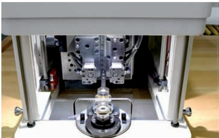
Une table tournante permet d'effectuer le chargement en temps masqué. Une ouverture à double paroi évite à l'utilisateur d'accéder à la partie usinage pendant le cycle et ainsi effectuer le chargement en toute sécurité.
