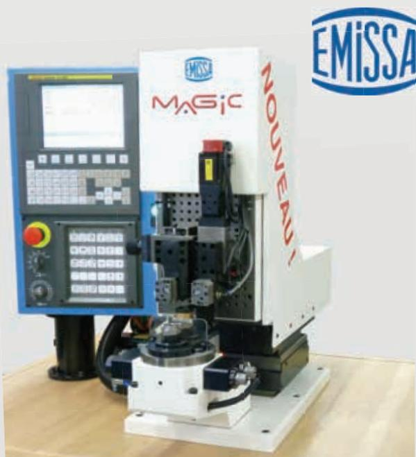
La société EMISSA a développé une solution d'usinage complète pour le perçage des trous de barrettes de montres. Cette machine d'établi baptisée MAGIC TOOL 50 utilise deux modules PIBOMULTI en simultané pour percer **à la perpendiculaire** entre les cornes. Une table tournante permet d'effectuer le chargement en temps masqué. Une documentation complète est disponible chez EMISSA.
